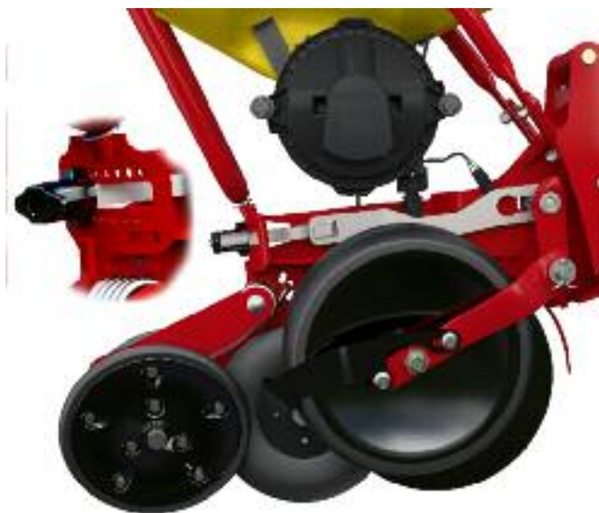
La profundidad de siembra es fácil de ajustar con una palanca que controla la relación entre la rueda de control y las semillas. La gran ventaja de los modelos arrastrados con ruedas es que para la máquina es más fácil dibujar y que las vibraciones en los cuerpos de siembra disminuyen.
