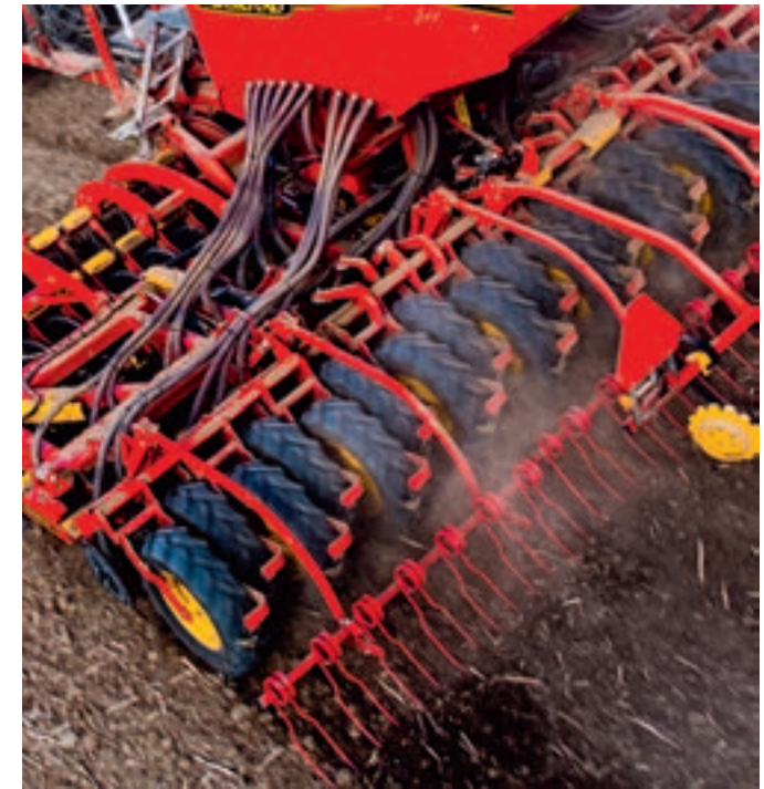
El montaje en OffSet permite que la siembra se pueda realizar en condiciones mucho más difíciles y permite a la máquina menos requerimiento de potencia.
