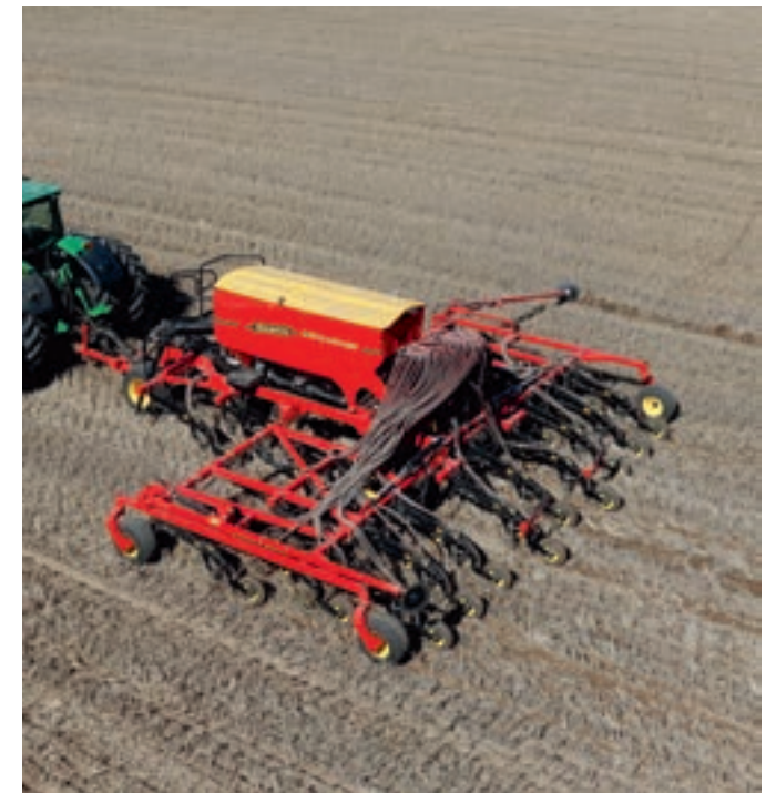
Seed Hawk deja semillas y fertilizantes a dos niveles diferentes evitando molestias entre sí y en una base labrada, las plantas y fertilizantes tienen acceso a la humedad del suelo.
