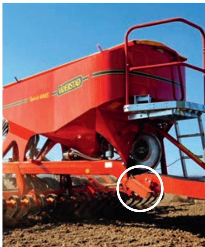
Para tener la mejor precisión posible, se utiliza un radar de suelo para medir la velocidad de trabajo con exactitud.
