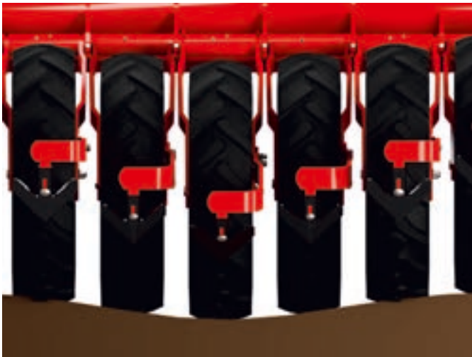
Las ruedas del sistema compactador siguen los contornos del suelo, asegurando reconsolidación y nivelación incluso en terrenos inclinados. Cada rueda presiona hacia abajo el suelo de dos filas de semilla y una fila de fertilizante.
