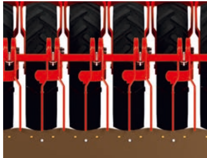
Las ruedas del sistema compactador siguen los contornos del suelo, asegurando reconsolidación y nivelación incluso en terrenos inclinados. Cada rueda presiona hacia abajo el suelo de dos filas de semilla y una fila de fertilizante.
