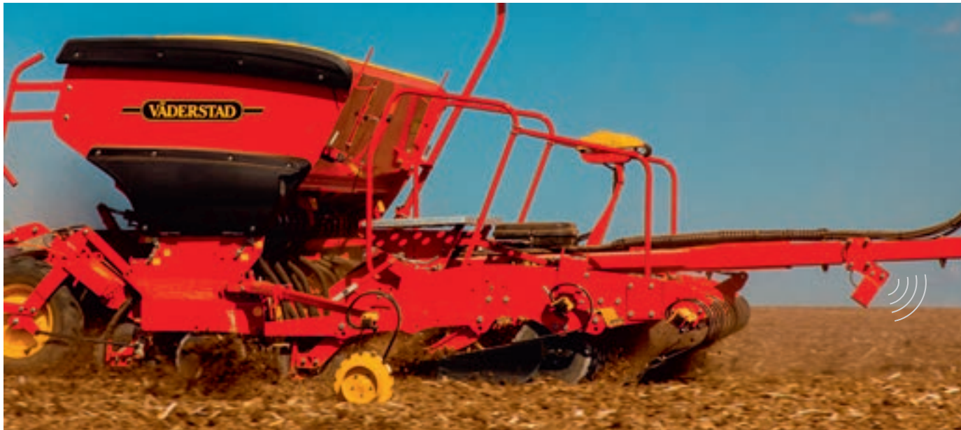
La densidad de siembra es controlada por radar en todos los modelos Rapid.
