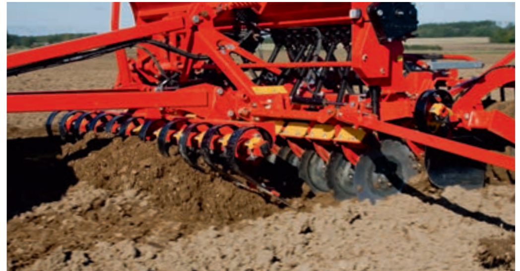
Crossboard desmenuza los terrones y los surcos para que la superficie del terreno se nivele. Crossboard está disponible opcionalmente.
