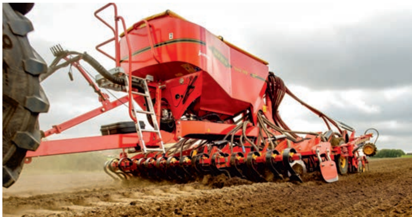
Con el método de FIX, el fertilizante es colocado en bandas con un espacio entre hileras de 12,5 cm.
