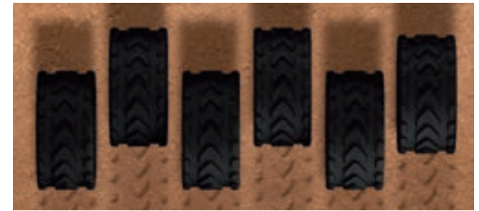
El posicionamiento Offset disminuye el requerimiento de potencia y otorga a la máquina una conducción más suave.
