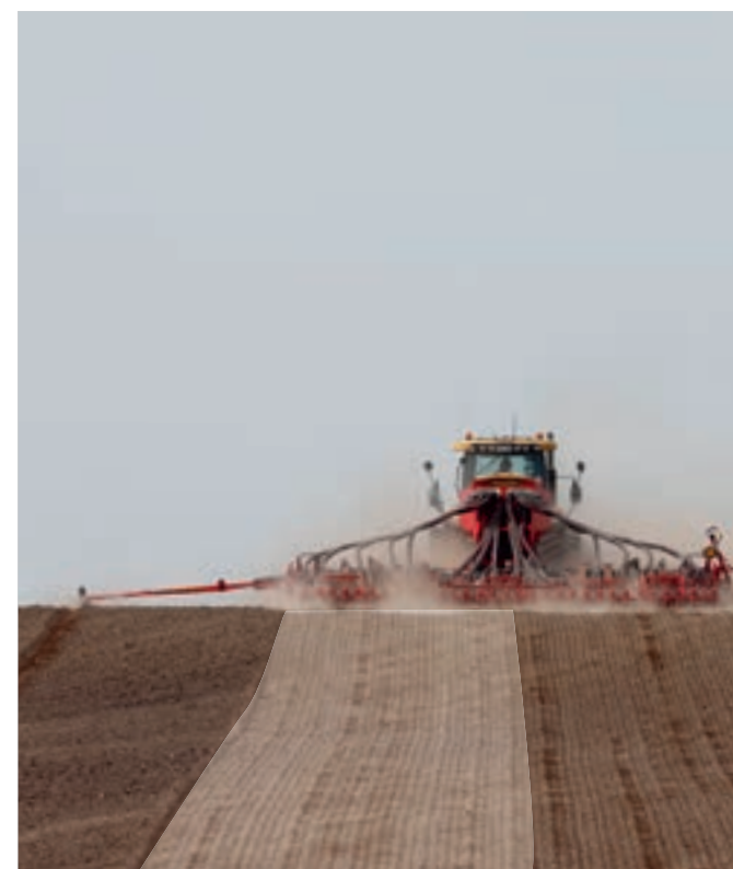
Con el cierre de la mitad de la máquina se evitan solapes de semilla y fertilizante y resultados de siembra irregulares.
