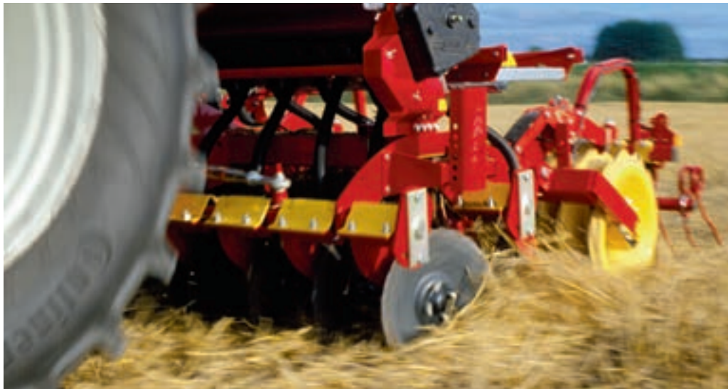
Los discos mezclan minuciosamente la paja en la capa superficial del terreno para que pueda comenzar la descomposición.
