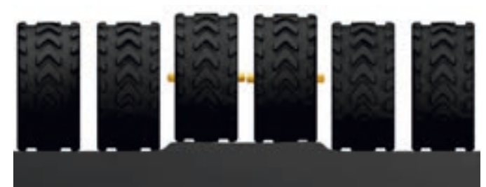
Las dos ruedas intermedias están montados sobre una cuna, lo que aumenta la seguridad durante el transporte en carreteras irregulares.
