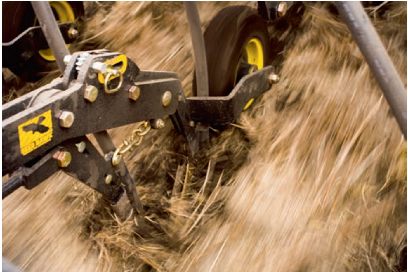
Los cuchillos de siembra de semillas están protegidos por placas de metal duro, que extienden considerablemente su vida.
