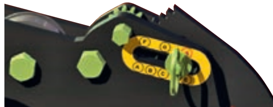
La profundidad de siembra se ajusta normalmente a la profundidad donde haya humedad en el suelo, con independencia de los cultivos. Mediante un pasador en el brazo de cuchillos, se puede ajustar fácilmente la profundidad utilizando una llave de 19 mm. La profundidad de siembra se ajusta individualmente en cada cuchillo de semilla.
