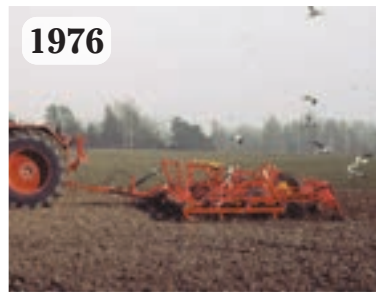
1976 En 1976 los límites desaparecieron con la SH-2, una gradilla de 14,8 m de anchura para grandes explotaciones.
