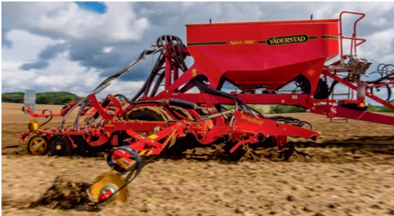
StripDrill es un ajuste de Spirit donde una nueva barra de herramientas permite el cultivo hasta 30 cm y la colocación de fertilizantes a dos profundidades diferentes.
