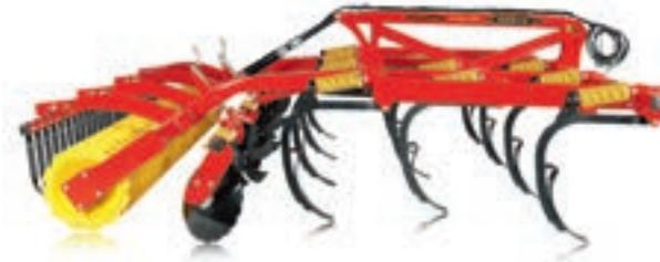
La máquina es espaciosa y tiene una altura de bastidor de 85 cm, lo que significa que puede permitir que grandes cantidades de residuos de suelo y de cultivos fluyan a través de él. La poderosa estructura principal está fabricado en tubo de perfil cuadrado (Dim. 100x100x10mm), ofreciendo una larga vida útil.
