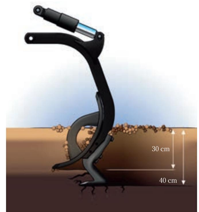
DeepLoosening se puede combinar con cualquier punta de mezcla o punta de ruptura en función del efecto requerido.
