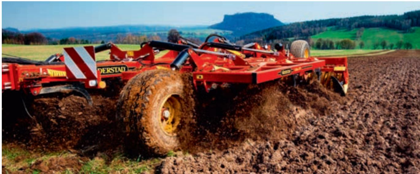
El espaciado entre los brazos en combinación con las espinillas MixIn crean un gran flujo a través del cultivador, donde la tierra se mezcla varias veces a medida que se lanza hacia adelante
