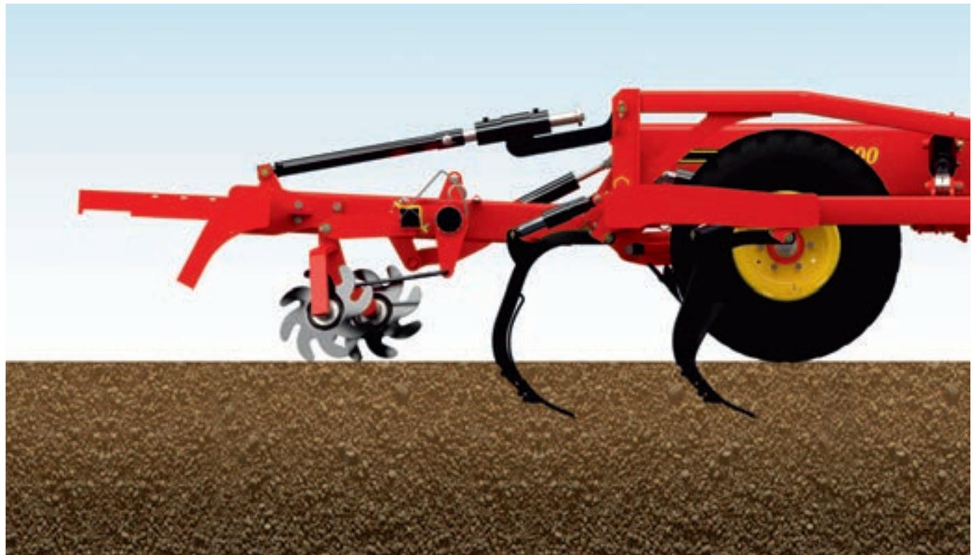
En condiciones de humedad, cuando no se necesita tanto peso en la máquina, el rodillo puede eliminarse por completo.
