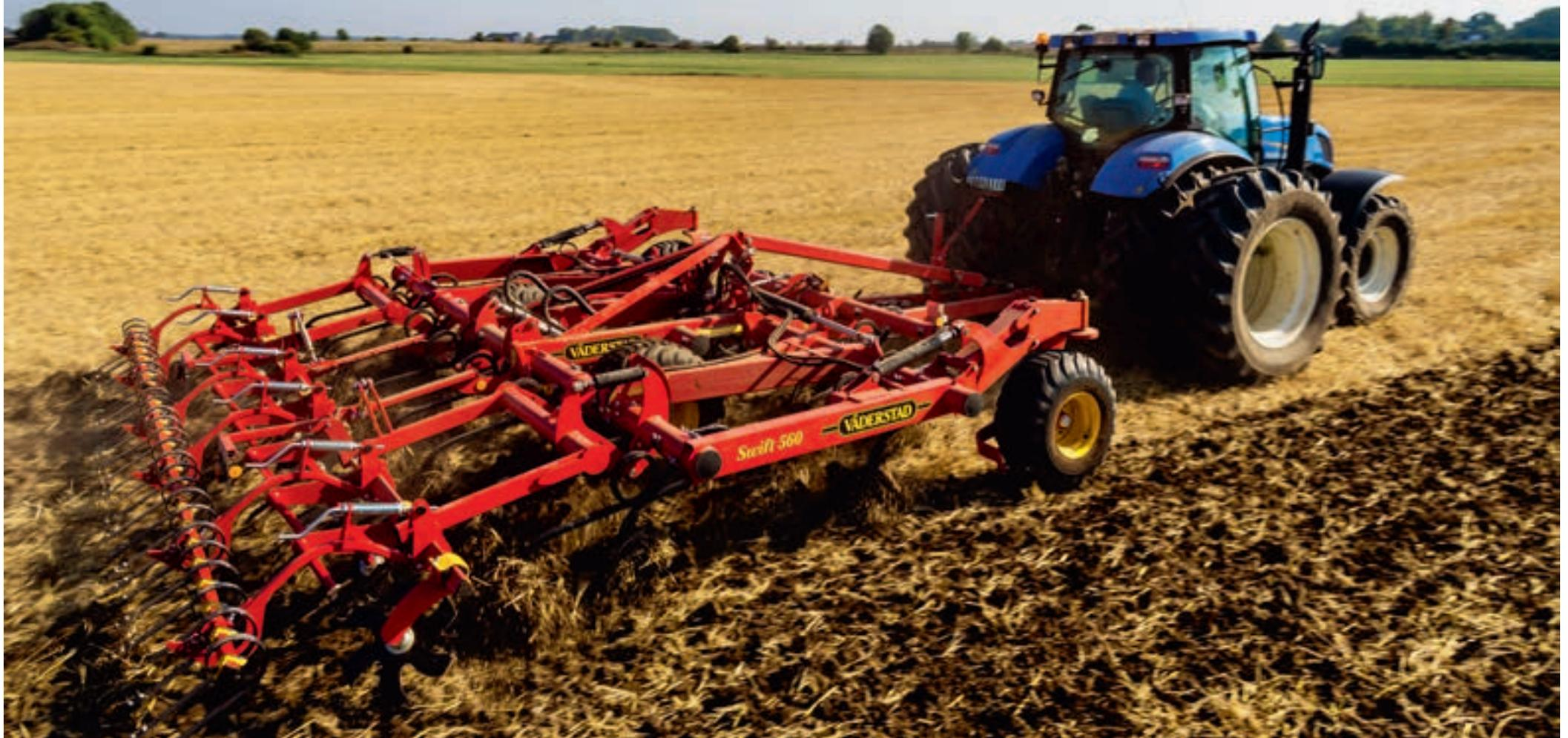
La construcción del marco abierto y espacioso, con 77 cm de altura sobre el suelo, significa que Swift puede permitir que pasen a través de las grandes cantidades de tierra y restos de cosecha. La máquina tiene un fuerte bastidor principal que puede hacer frente a las tensiones, dándole una vida más larga.
