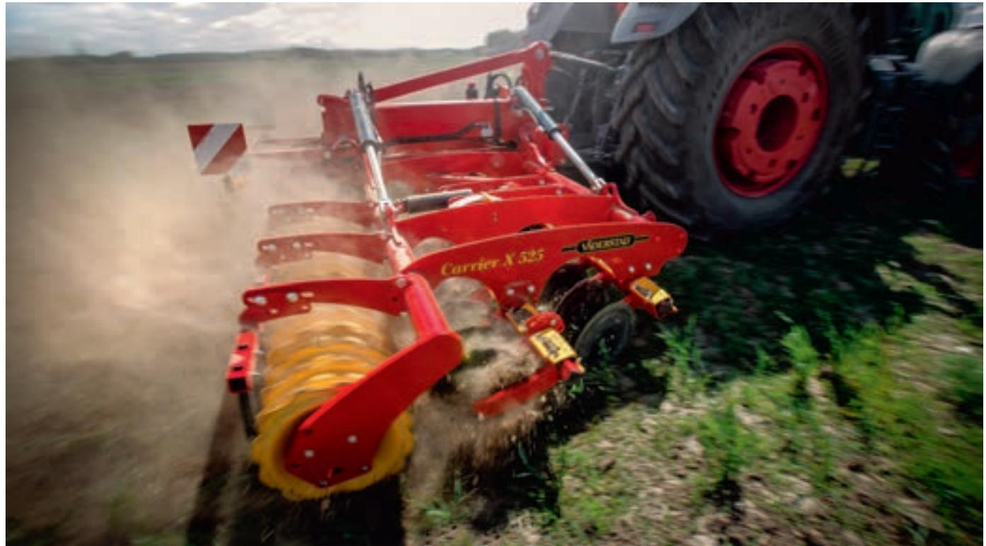
La posición de los discos en forma de X permite que trabajar vinculado a GPS. El ángulo del disco asegura una buena capacidad de penetración.
