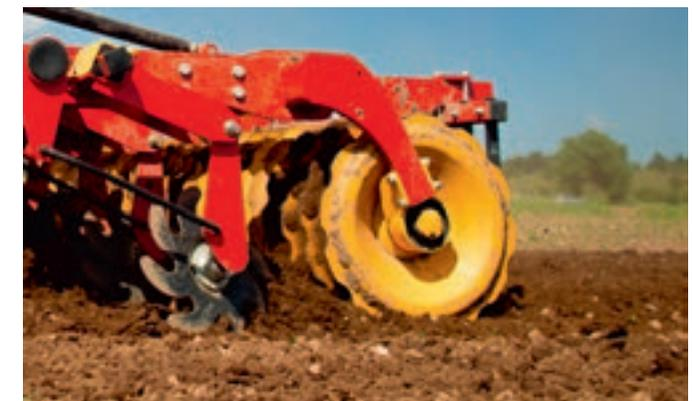
SteelRunner es un rodillo de montado con goma y fabricado de acero especial V-55.
