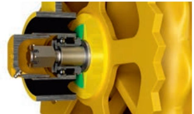
La amortiguación de goma es una solución única que asegura al rodillo Väderstad gran durabilidad. La placa de resorte (color verde) mantiene el conjunto de rodillos en tensión.
