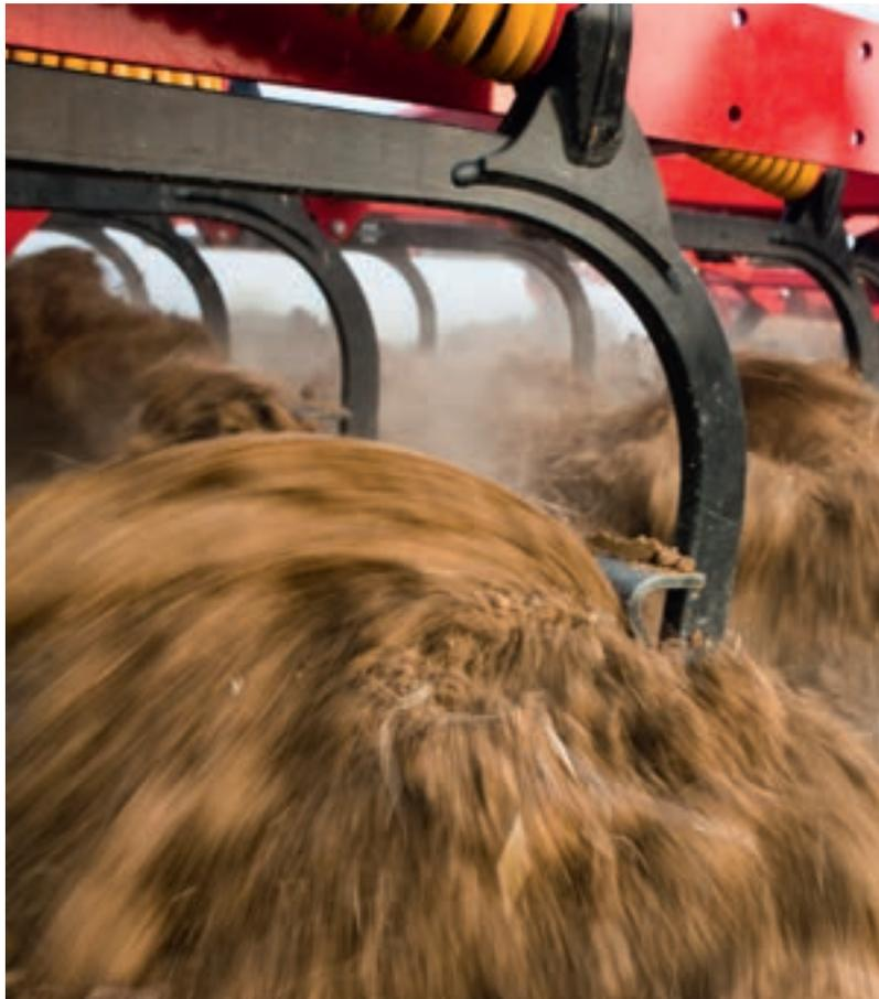
Corta y mezcla la capa superior del suelo. Eficaz para el control de ratones.
