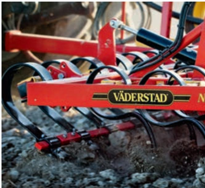
La barra CrossBoard de Väderstad se suministra con una barra estabilizadora de acero especial endurecido de serie.
