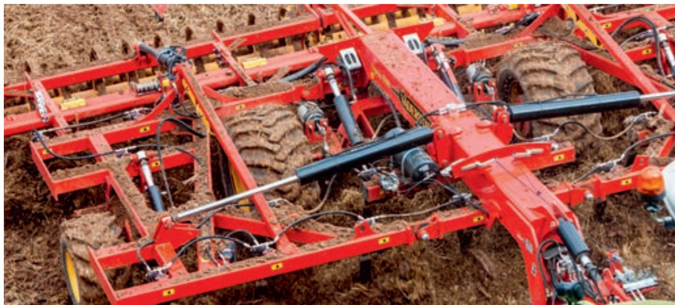
Cuando está equipado con puntas DeepLoosening, Opus puede romper suelas hasta 40 cm de profundidad. Para disminuir la necesidad de potencia, Opus también puede montarse con puntas LowDisturbance y púas plegables.
