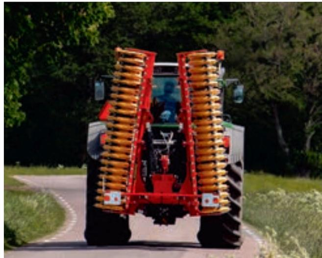
Plegado en la posición de transporte, Carrier X es sólo 2,4 m de ancho y tiene una impresionante altura libre al suelo.
