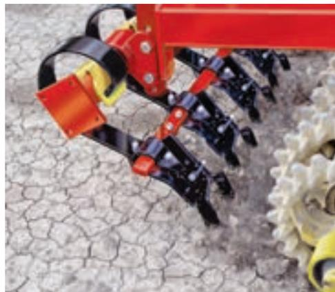
Para mejorar aún más el efecto de cultivación y trituración de CrossBoard, se puede equipar con cuchillos de acero endurecido y afilado, SingleKnife. Las herramientas DoubleKnife de rotura de costra pueden romper el endurecimiento de la superficie que se presenta a menudo en suelos limosos después de fuertes lluvias. Estos cuchillos se pueden montar sin herramientas con el sistema QuickChange Väderstad.
