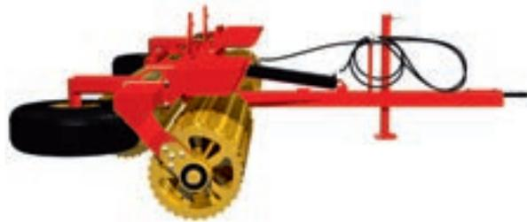
Chasis potente con grandes bandejas para piedras como opción y con dispositivo de bloqueo automático. Este dispositivo de bloqueo impide el despliegue accidental del rodillo durante la marcha atrás. El paso de modo transporte a modo de trabajo puede ser gestionado desde la cabina del tractor.
