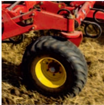
Swift 560 tiene grandes ruedas de apoyo pivotantes como opción. Las ruedas de apoyo se controlan hidráulicamente con un sistema maestro / esclavo. Swift 640, 720 y 870 están equipados con grandes ruedas de apoyo.
