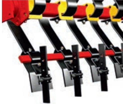
En el cultivador con el cuchillo SingleKnife montado en Crossboard, el efecto de cultivación recibe una mejora adicional. Usando el sistema QuickChange de Väderstad, estos cuchillos se pueden montar sin necesidad de herramientas.
