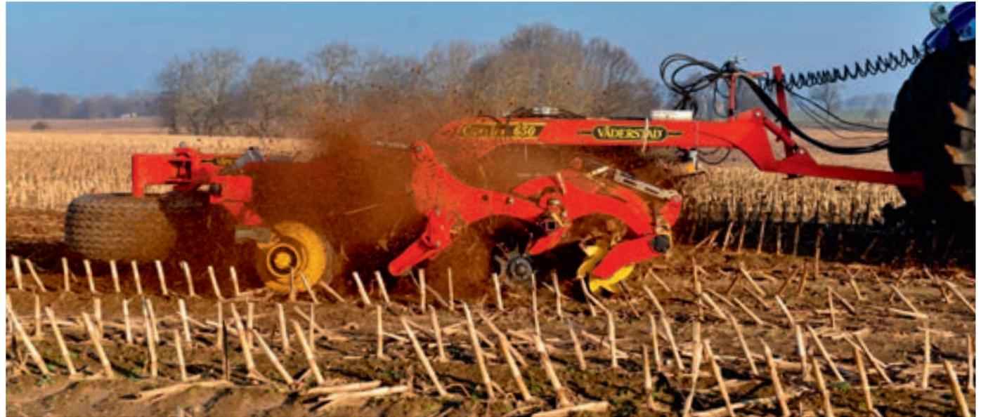
La combinación CrossCutter Knife-Disc controla la polilla del maíz por rotura de los tallos de maíz entre los nudos. Seguidamente el rodillo de acero SteelRunner aplasta los residuos y los mezcla con el suelo.
