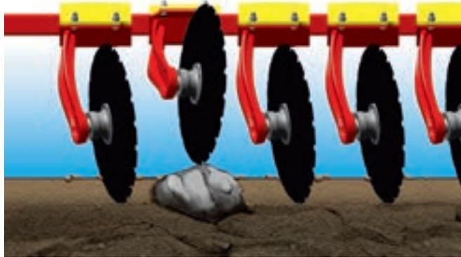
Los discos están montados individualmente sobre una amortiguación de goma y están completamente libres de mantenimiento. Esto mejora la precisión en las direcciones vertical y horizontal y permite un buen flujo de material a través de ellos.
