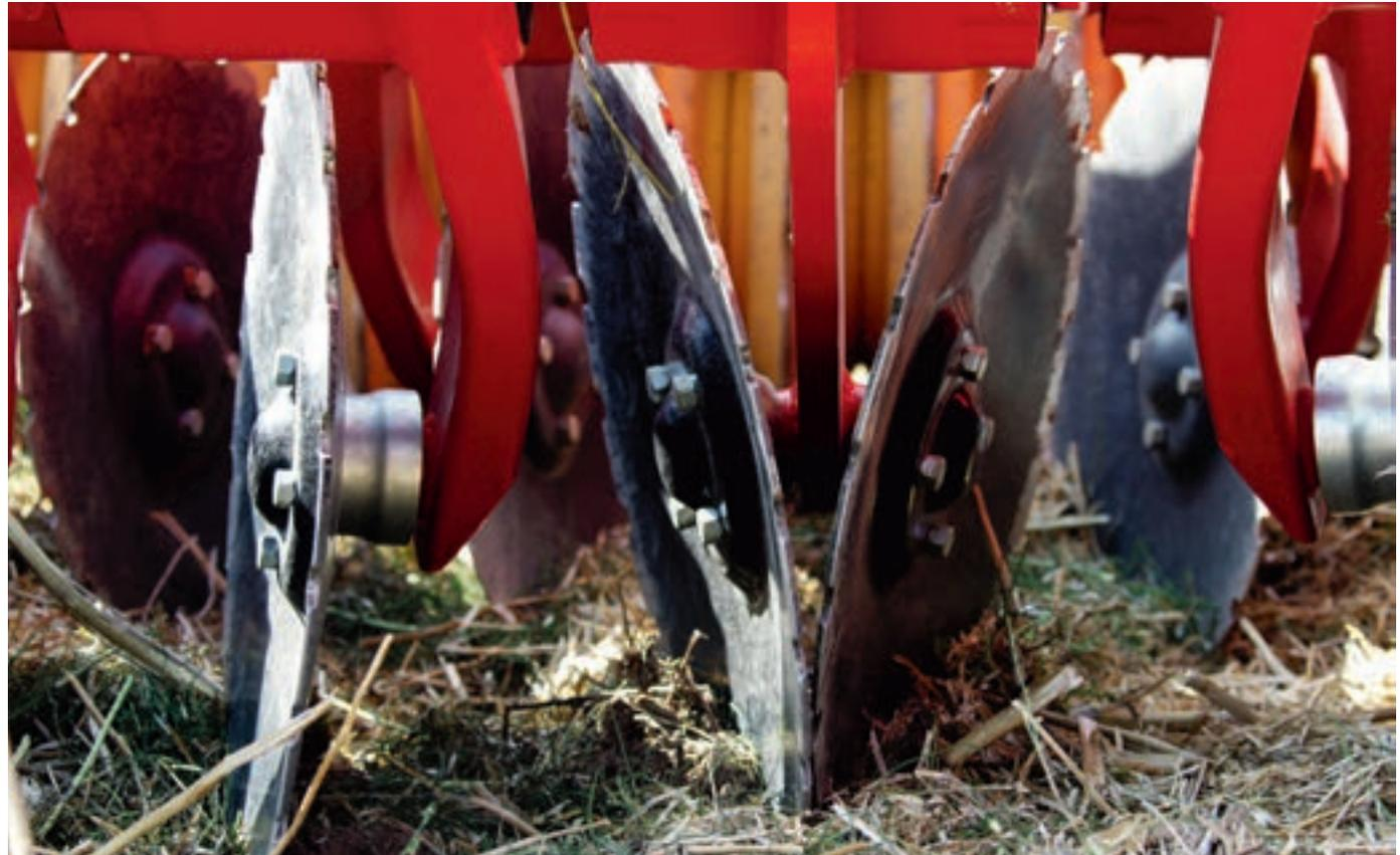
La forma de X de la máquina hace que actúe como un modo de abrazado del suelo y la mantiene trabajando en línea recta de manera impresionante.
