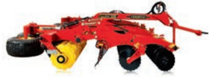
La amortiguación de goma en el rodillo de acero absorbe los impactos y alarga la vida de la estructura y del rodillo.
