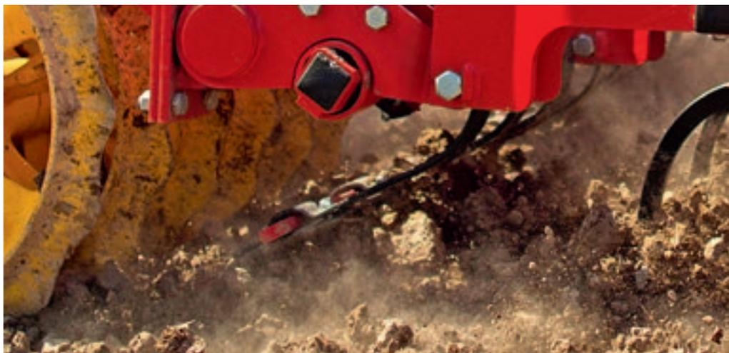
CrossBoard con barra estabilizadora de doble acción se usa después de arar para aplastar terrones y nivelar. Si CrossBoard se utiliza para nivelar en la cultivación de rastrojo, este trabajo debe hacerse sin la barra estabilizadora.
