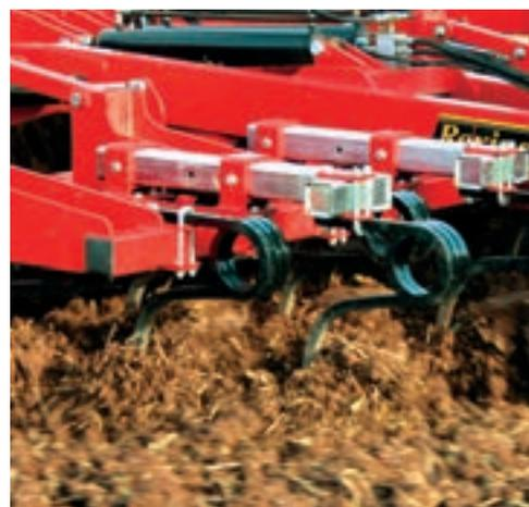
Para aumentar el espaciado entre los brazos en la barra de herramientas, el rodillo puede ser modificado agregando un tercer eje. Esto proporciona un mejor flujo del suelo y más de paso de paja y restos de cosecha
