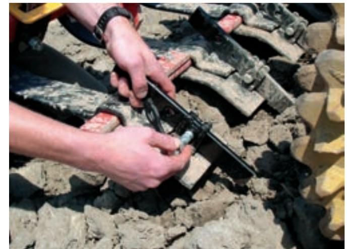
Para aumentar aún más el efecto de cultivación y trituración de CrossBoard, puede ser equipado con cuchillos afilados y endurecidos SingleKnife. Éstos se pueden montar en su sitio sin necesidad de herramientas utilizando el sistema QuickChange Väderstad.
