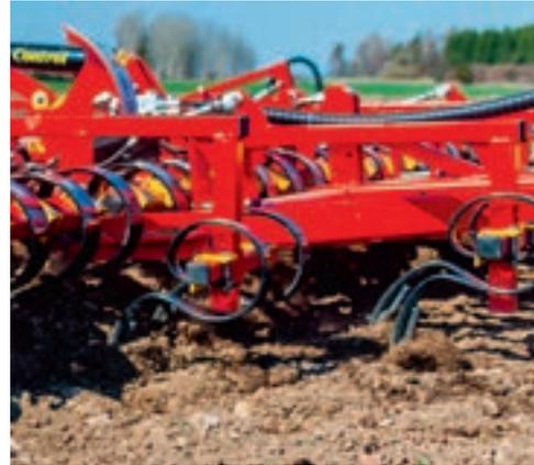
Los borra-huellas eliminan eficazmente las huellas dejadas por el tractor y se pueden ajustar de forma individual a la profundidad deseada. Borra-huellas están disponibles para ruedas estándar (Dientes 2x2) y para ruedas dobles (Dientes 4x2).
