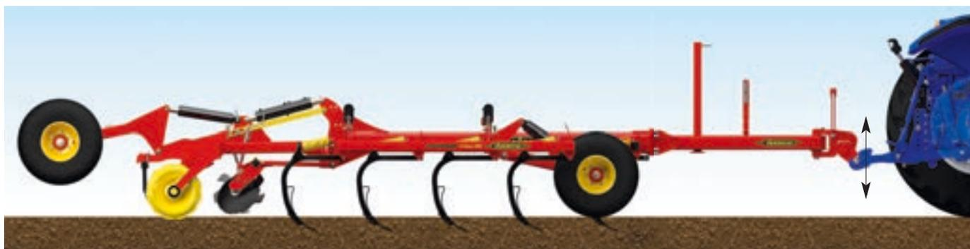
Con la barra de tracción hidráulica bien ajustada, el requisito de potencia se puede bajar.
