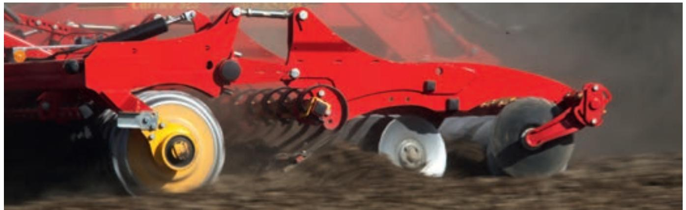
La barra estabilizadora de doble efecto permite la nivelación en dos direcciones, hacia delante y hacia atrás.
