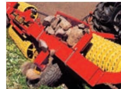
Las bandejas se vacían fácilmente desde la cabina mediante el sistema hidráulico del rodillo.
