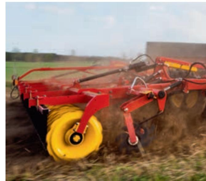
SteelRunner rompe la superficie y presiona la paja en una capa de poca profundidad a fin de lograr la tasa de descomposición óptima.
