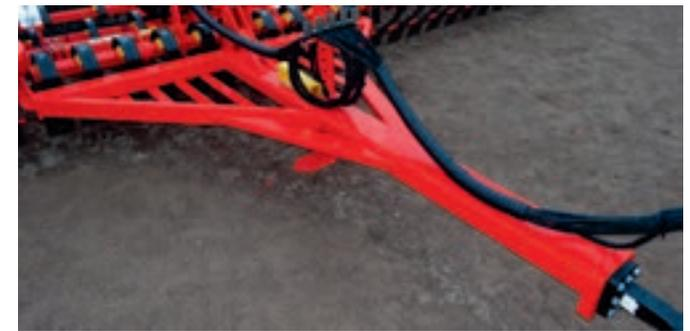
La nueva barra de tiro mide 200x100 y es de 10 mm de espesor. La barra de tracción anterior era 120x120x 8 mm de espesor.
