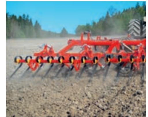
Swift se puede equipar con cualquiera de 12 mm después de puas grada o de gran alcance, que salte dientes labrador de 9,5 x 45 mm.
