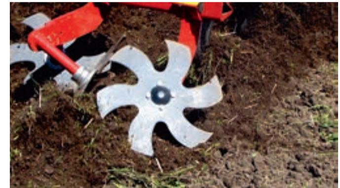
Los niveladores rotativos sin grasa se montan sobre una amortiguación de goma en un eje triangular. TriForce que da un rebote estable con fuerza constante, lo que favorece una acción de nivelación sensible del suelo. La amortiguación de caucho absorbe los impactos y las vibraciones, y protege al marco.
