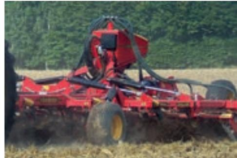
BioDrill 360 con tolva neumática está diseñado para ser instalado en los Cultus más grandes.
