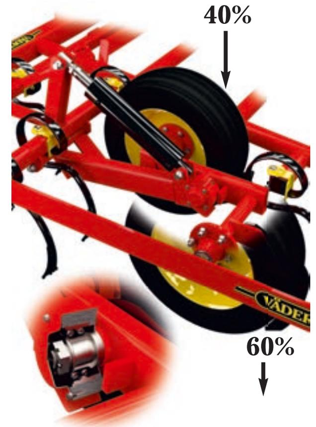
Tener 40% de la carga sobre las ruedas de los bogies delanteros y el 60% en la parte trasera le permite adaptarse de forma impresionante al contorno del suelo y ser un bogie "rápido" que controla de manera eficaz en un terreno irregular. Las unidades de rodamientos de bolas con contacto en ángulo absorben eficientemente cualquier fuerza lateral perjudicial que pueda surgir.
