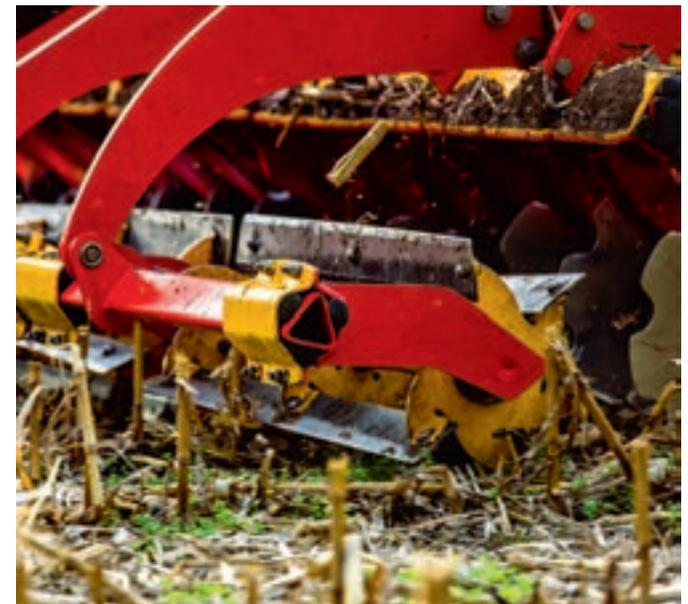
Hojas de cuchillo cortas, y el diámetro del rodillo base estrecho, garantizan buena capacidad adaptación al contorno y alta velocidad de rotación durante el trabajo.
