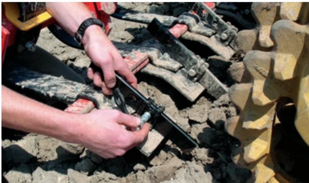
SingleKnife. Fácil de instalar en las puntas CrossBoard con el sistema QuickChange Väderstad.
