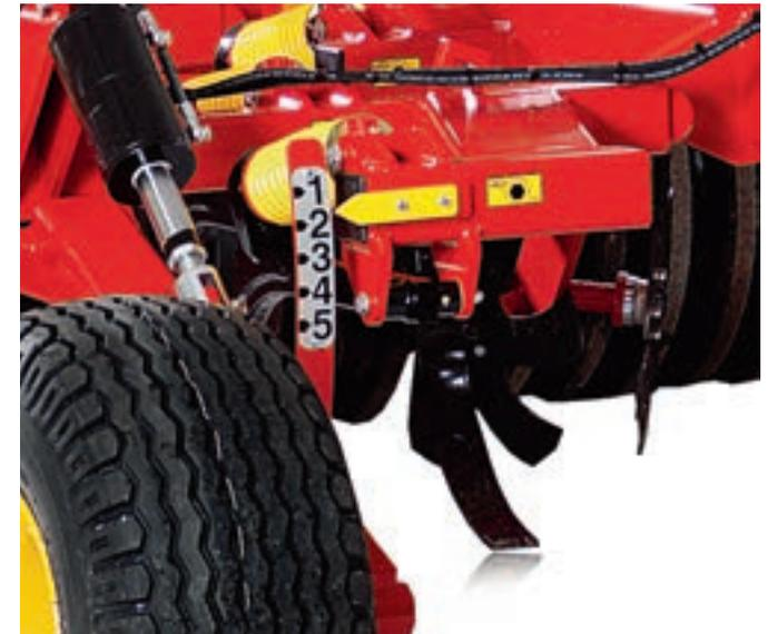
La profundidad de trabajo se ajusta hidráulicamente desde la cabina y los cambios se muestran en una escala numerada y clara.
