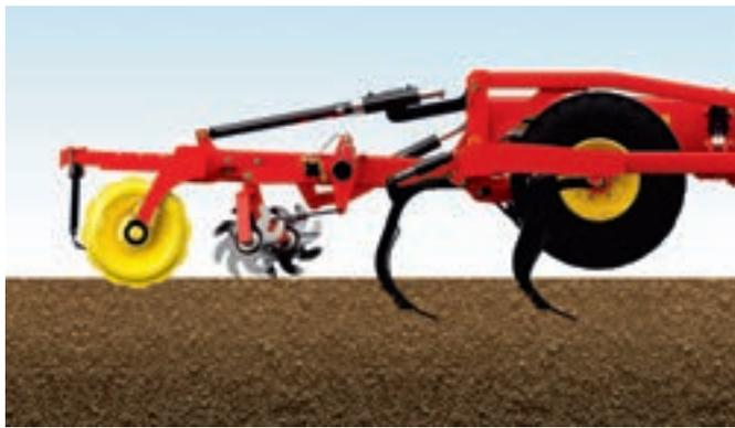
En condiciones secas, todo el peso de la máquina se puede cargar sobre el packer.
