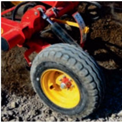
Swift 560 está equipado con ruedas de apoyo individuales con ajuste hidráulico desde la cabina de serie.
