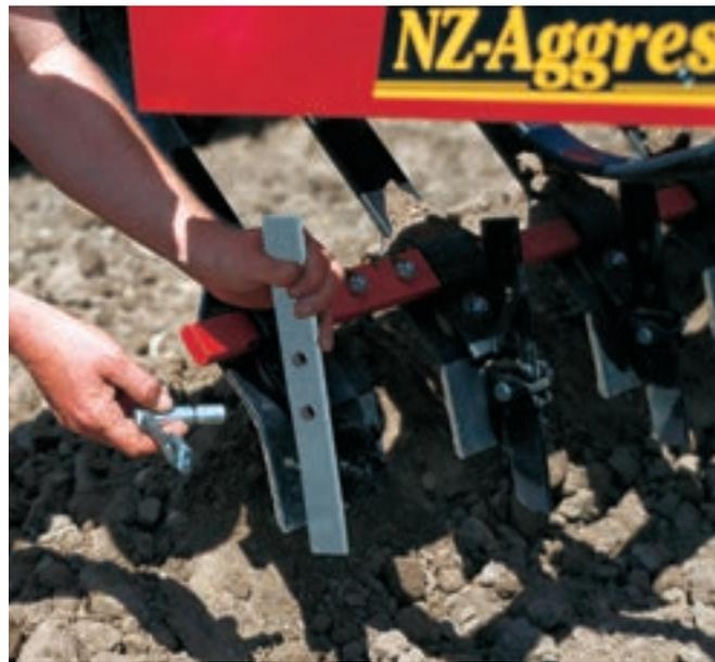
Con la herramienta SingleKnife montada en CrossBoard, el efecto de cultivación aumenta. No se necesitan herramientas para el montaje gracias al sistema QuickChange Väderstad.
